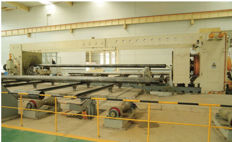
近日,庆阳能源化工集团和盛装备制造园螺旋焊管生产车间,工人们正在加班加点生产发往华池县第二批螺旋焊管。图为车间一角水压力测试场景。(王尧 摄)
