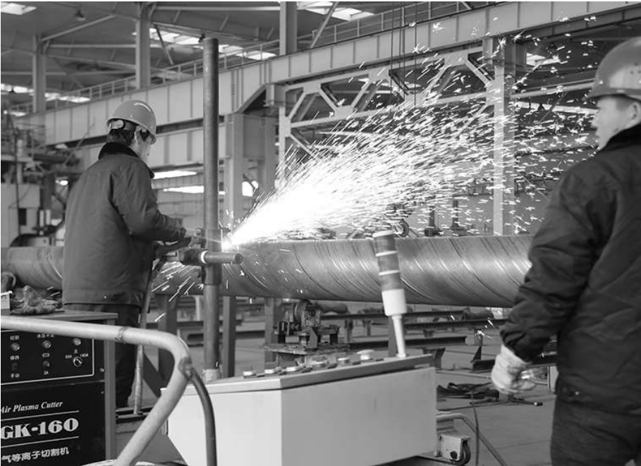
图为螺旋焊管车间工人正在作业
